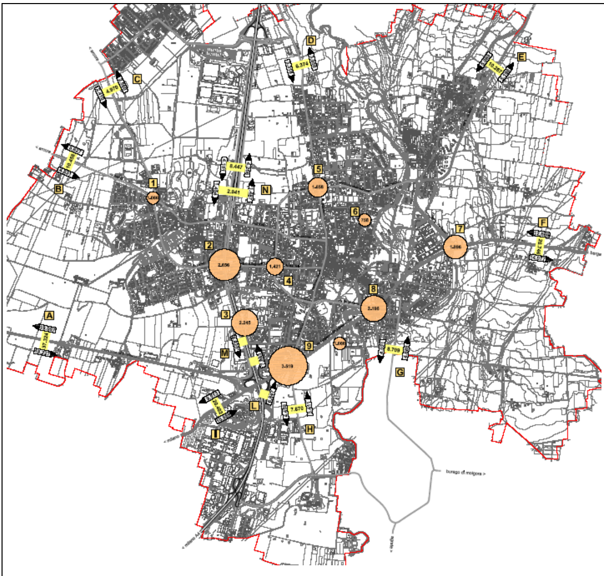
Fonte: PUT quadro conoscitivo e rapporto criticità (tavola 7 – traffico giornaliero medio al cordone e valori ai nodi )
